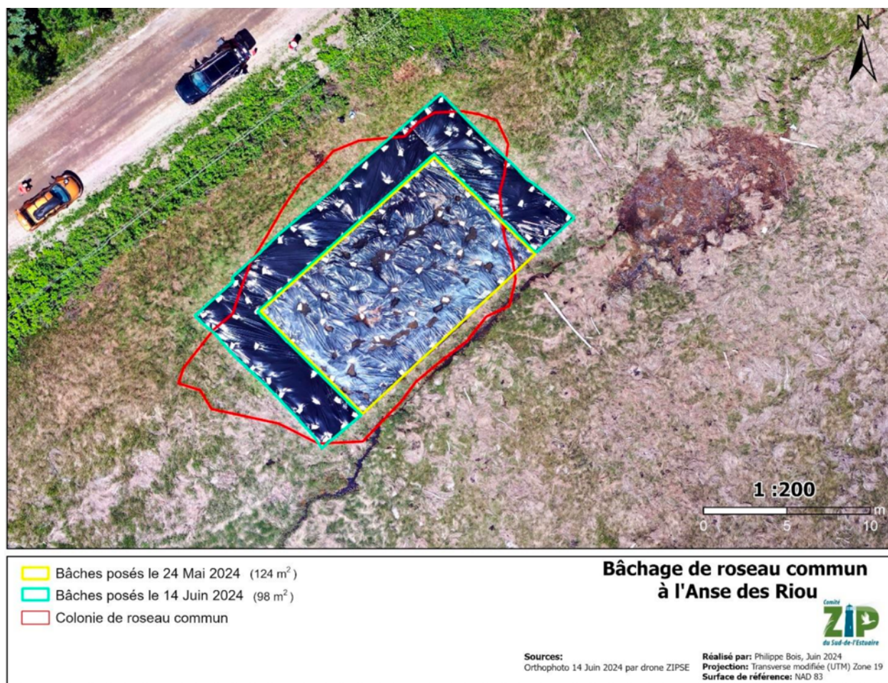
Figure 5 - Dispositif de contrôle du roseau commun installé à l'Anse des Riou en 2024
